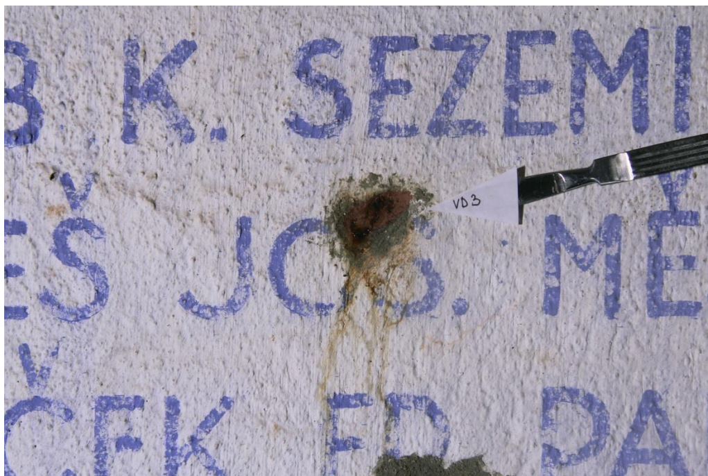
Obr. 24 Detail odběru vzorku VD3 z místa bílé vrstvy, podkladová (okolí písmenka z jmenného seznamu).
